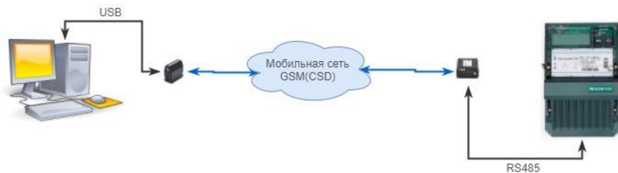
Рисунок 1.1 – Конфигурирование счетчика по каналу GSM
