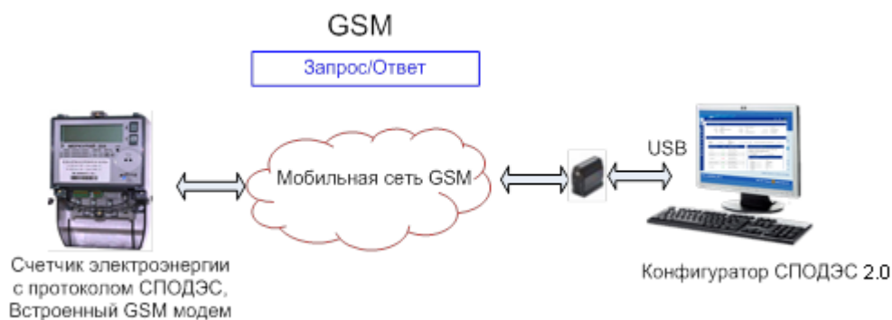
Рисунок 1.2 – Конфигурирование счетчика, GSM
