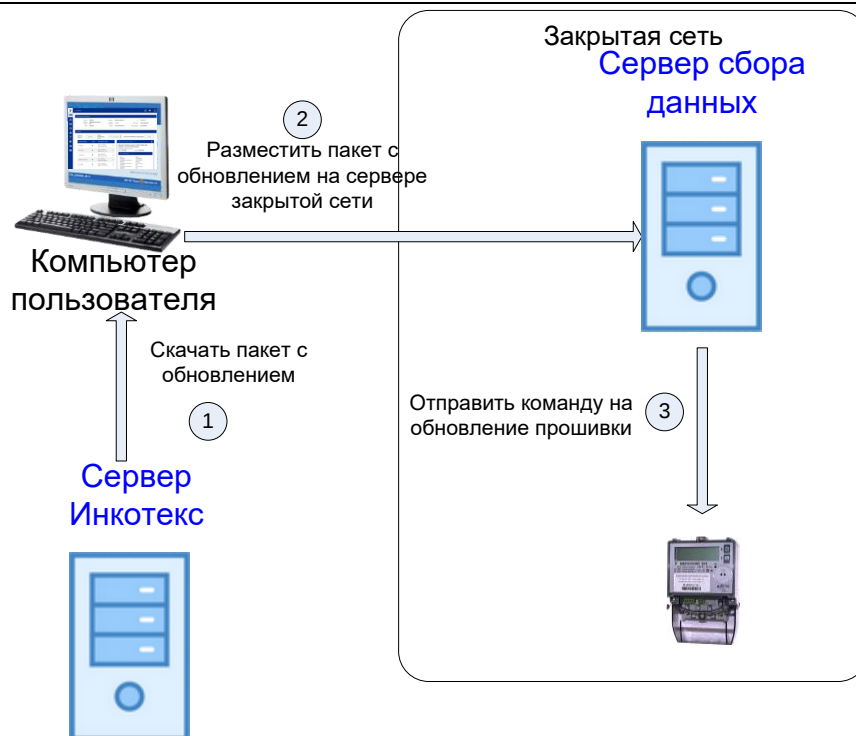
Рисунок 3.2 – Схема удаленного обновления прошивки для закрытой сети
