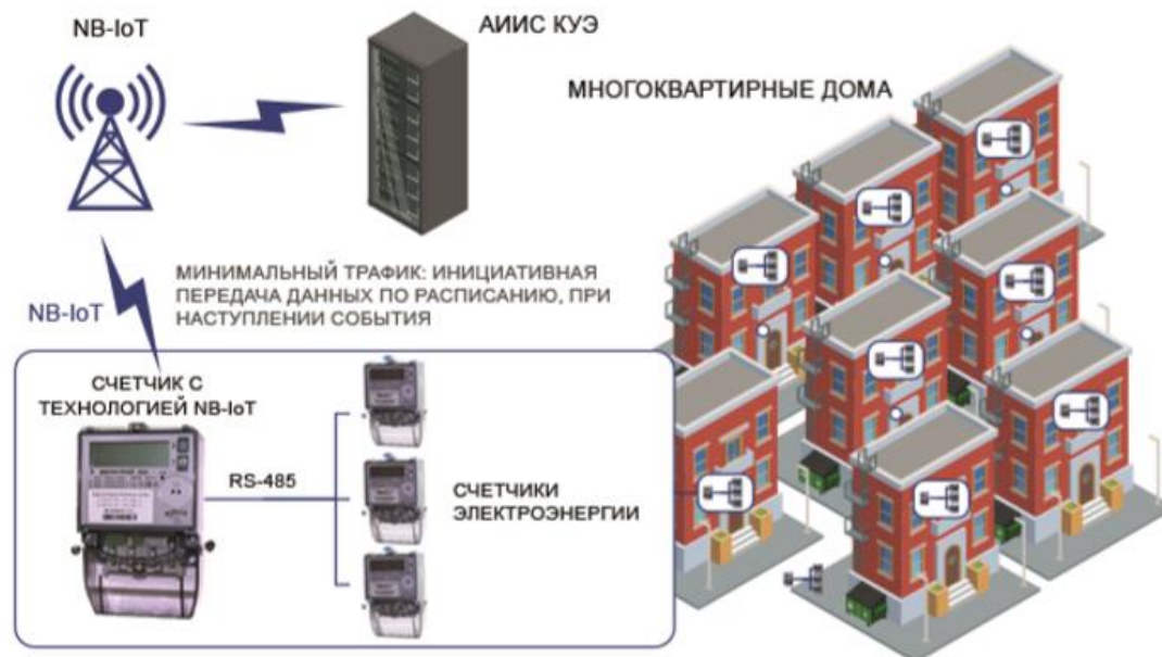
Рисунок 1.2 – Схема работы счетчика с модулем NB-IoT в составе АИИС КУЭ
