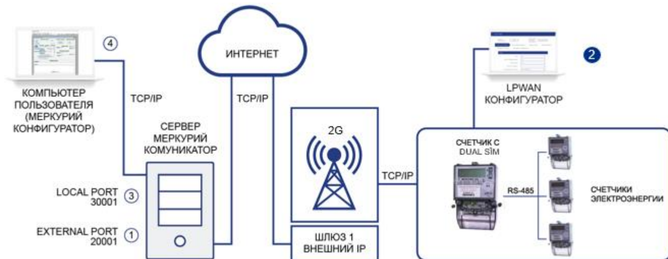
Рисунок 3.1 – Схема работы в режиме прямого канала
