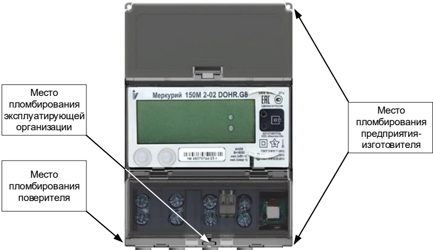
Рисунок 4.1 – Вид счетчиков Меркурий 150М, Меркурий 150, Меркурий 150Х с указанием мест пломбирования
