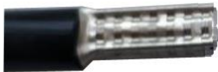
Рисунок 6.1 – Обжим провода СИП наконечником НШВ 16-18
