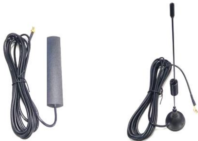
Рисунок 5.3 – «Лепестковая» (слева) и «штыревая» (справа) антенны
