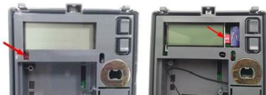
Рисунок 4.1 – Расположение переключателя блокировки управления нагрузкой счетчика «Меркурий 204»
