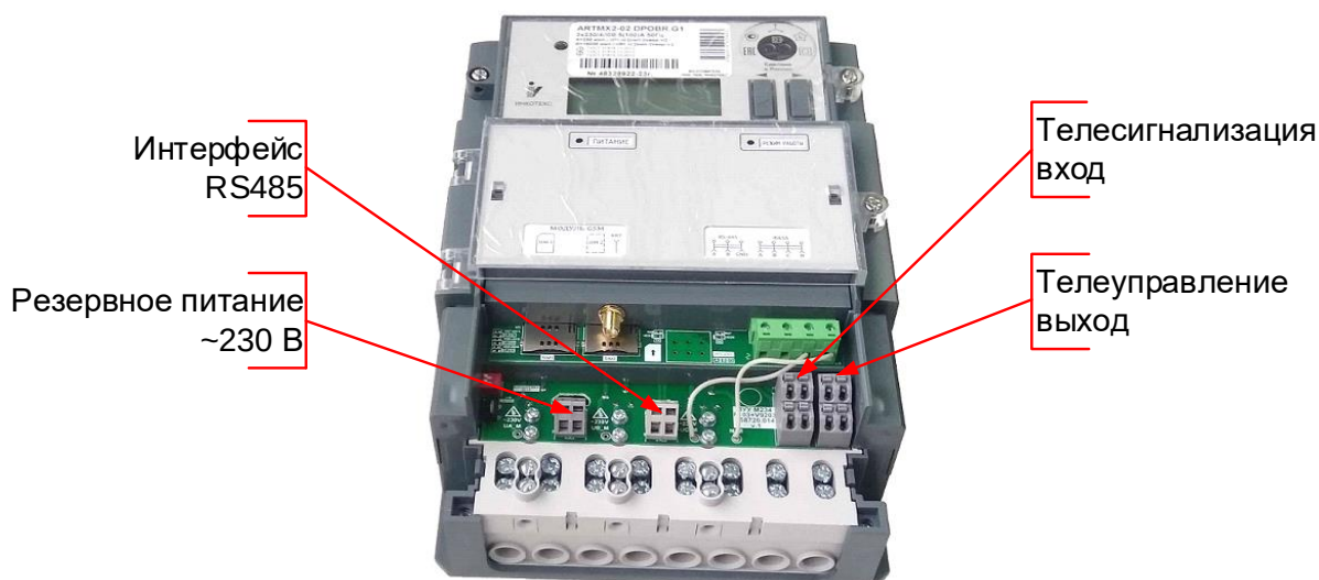
Рисунок 5.5 – Элементы подключения счетчика «Меркурий 234» с индексом «Х»
