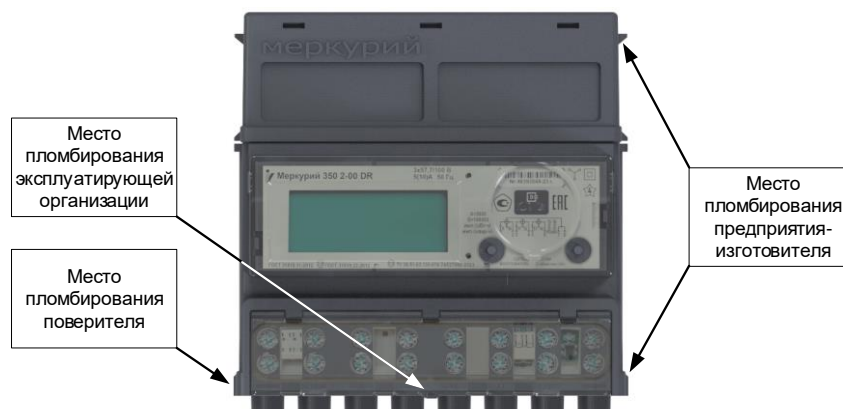
Рисунок 4.1 – Вид счетчиков Меркурий 350М, Меркурий 350 с указанием мест пломбирования и нанесения знака поверки
