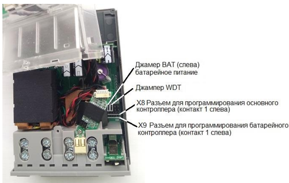
Рисунок 2.4 – Расположение джамперов и разъемов
