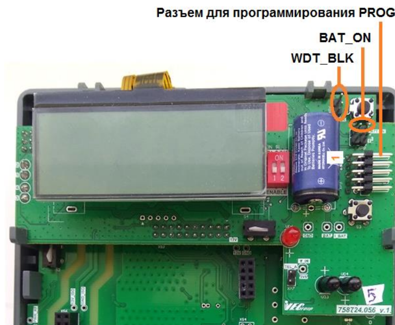
Рисунок 3.1 – Расположение джамперов
