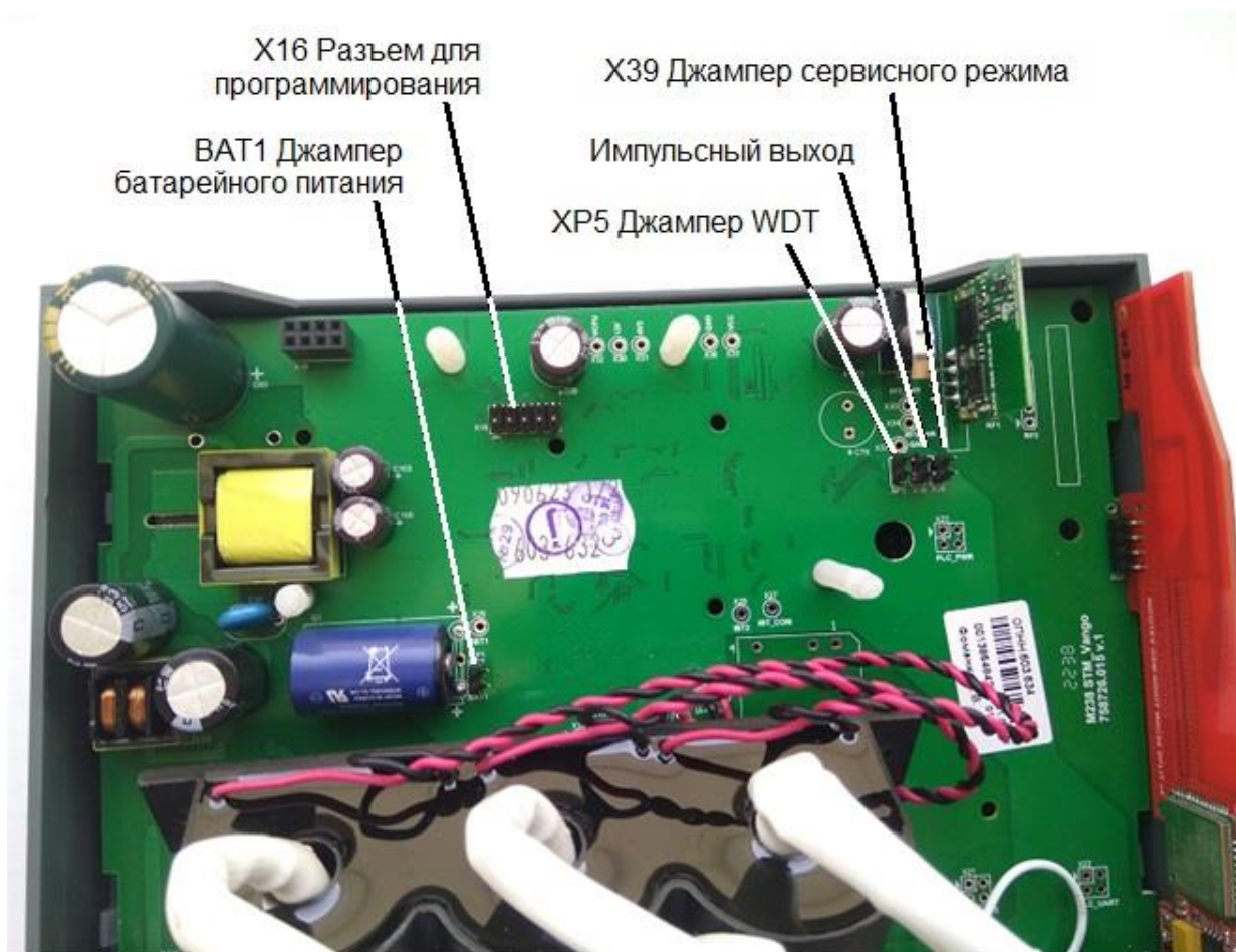
Рисунок 4.1 – Расположение джамперов
