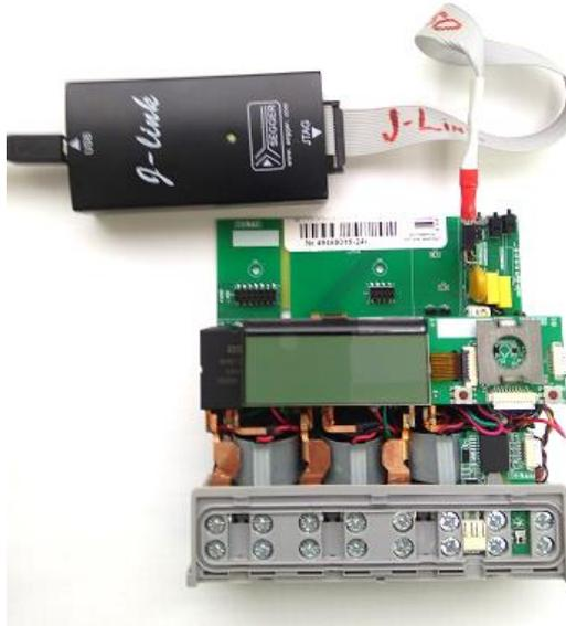
**Рисунок 5.1 – Подключение кабеля для программирования**
